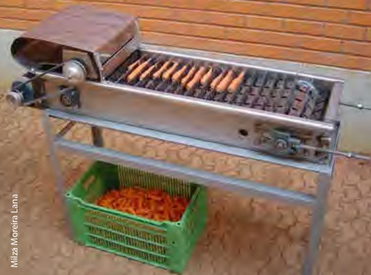
A Cortadora Horizontal corta as raízes em pedaços ideais para o processamento de cenouretes
